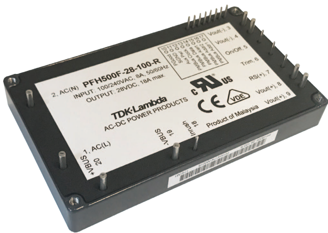
500-W-AC-Frontend mit brückenloser PFC in GaN-Technologie von Transphorm, Synchrongleichrichter und digitalen Isolatoren statt Optokopplern in der Regelschleife
