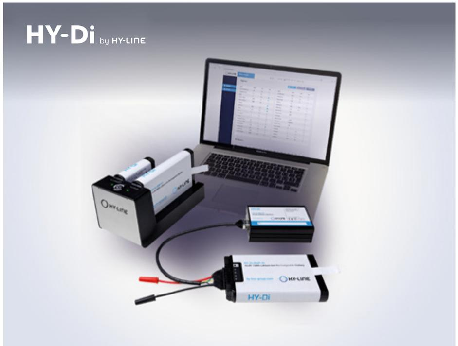
Die Batterie-Diagnose kann drahtlos während des Betriebs und in der Ladestation durchgeführt werden.
